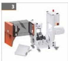
Den Rahmen mit den Statormessern aufklappen, dann sind die Zahnwalzen und die Vorbrecher frei zugänglich.
