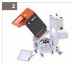
Seitlicher Schraubverschluss von Hand öffnen und den Schacht nach vorne klappen.
