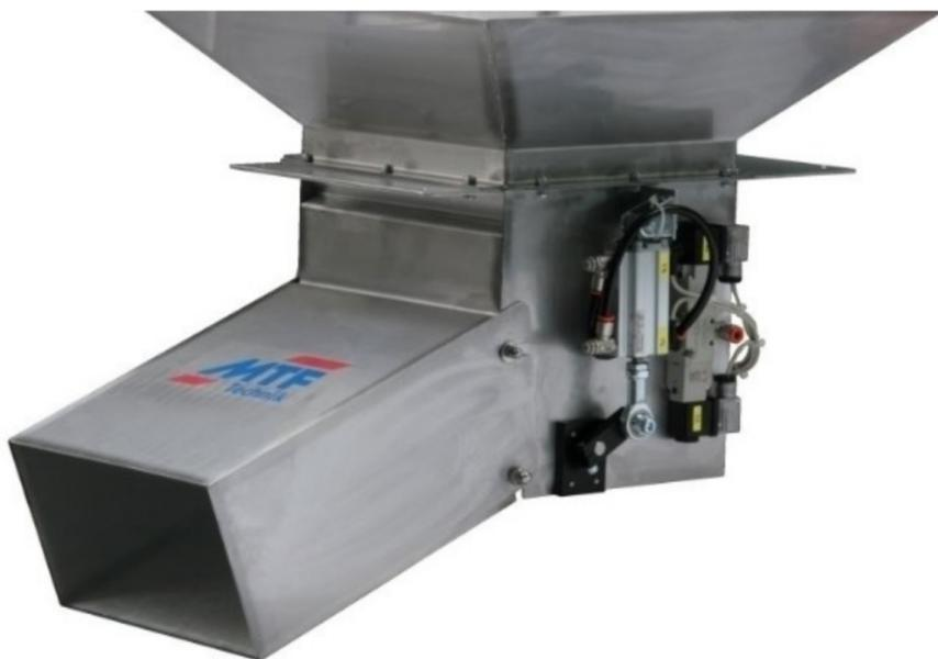
2-Wege Ausfallweiche für eine Demag Ergotech ET 50/270 Spritzgießmaschine
