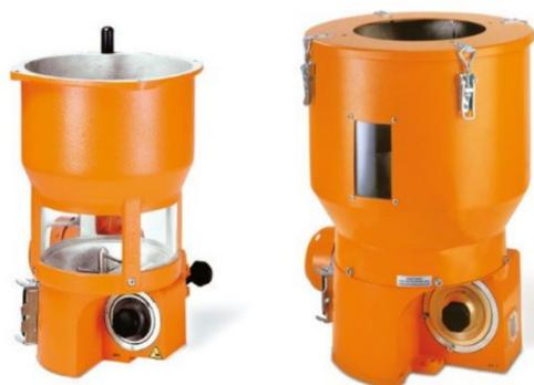
Volumetrische Dosierstationen für Neuware oder Mahlgut Ma 1 bis Ma 5 Grobkörniges Granulat oder gut rieselfähiges Mahlgut wird mit einer Ma-Station zudosiert. Dabei unterstützt ein Rührwerk das robuste Zellenrad aus V2A Edelstahl. So werden auch scharfkantige Körner dosiert, ohne sich zu verklemmen.
