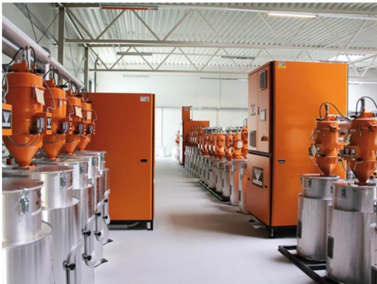
Eine Reihe von 3 CKT-Trocknern mit Trocknungsbehältern für mehr als 25 verschiedene Materialien.
