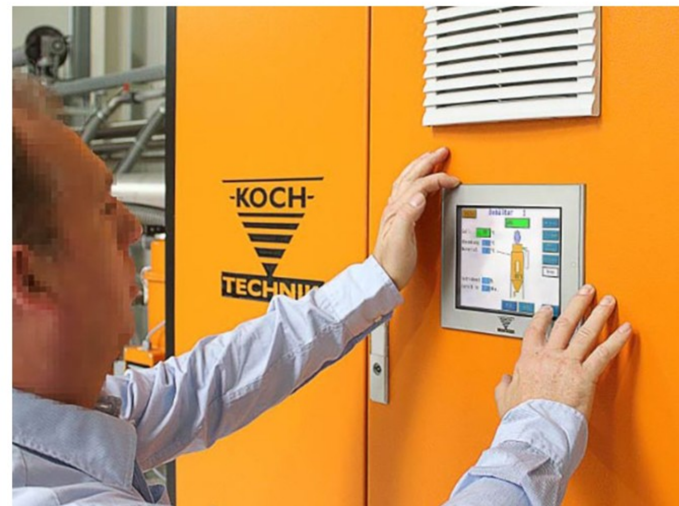
Die optionale Touch-Panel-Steuerung erleichtert die Überwachung der Trocknungsprozesse.
