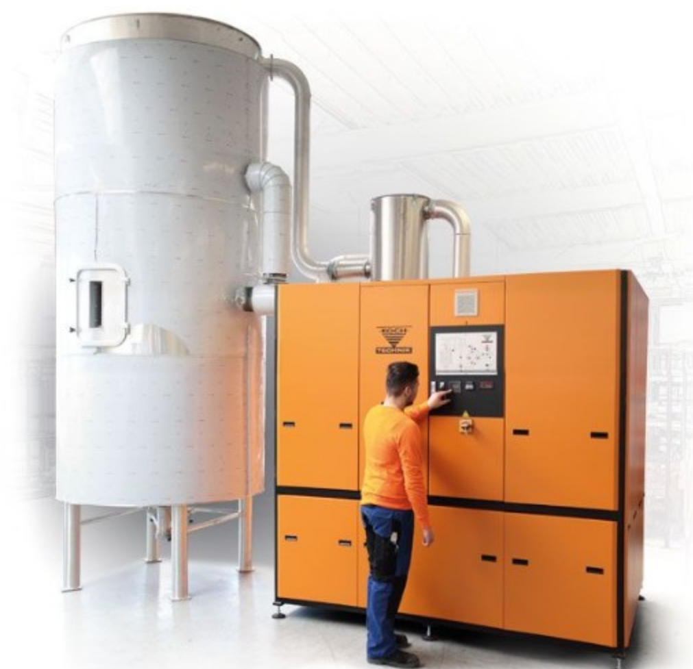
Einer von insgesamt 6 Granulattrocknern Typ CKT1700 kurz vor der Auslieferung nach China. Der Verbund aus 6 CKT1700 Trocknern mit einer Kapazität von 10200 m³/h versorgt heute 10 Extruder mit kalkulierten 5750kg Material pro Stunde.
