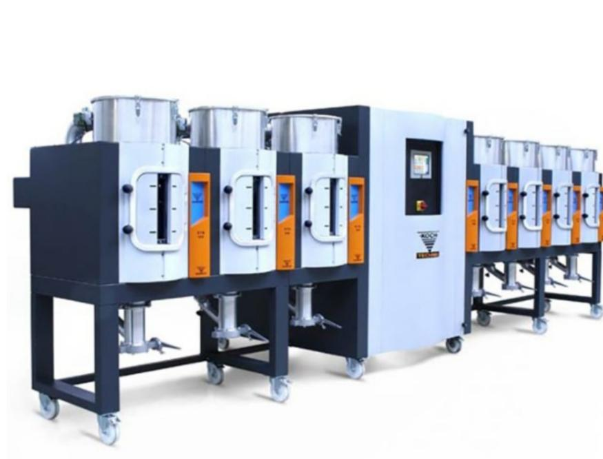
Bei Trockenlufttrocknung ohne Taupunktsteuerung wechseln sich die Trockenmittelbehälter in festen Zyklen bei Entfeuchtung und Regenerierung ab. Dabei werden die Durchsatzmengen und der Feuchtegehalt des zu trocknenden Materials nicht berücksichtigt.
