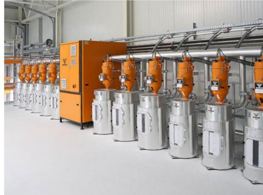
**Unsere ÖKO-Anlagensteuerung garantiert, dass hygroskopische Materialien wie PA, PC, LCP, POM usw. nicht übergetrocknet werden:**
