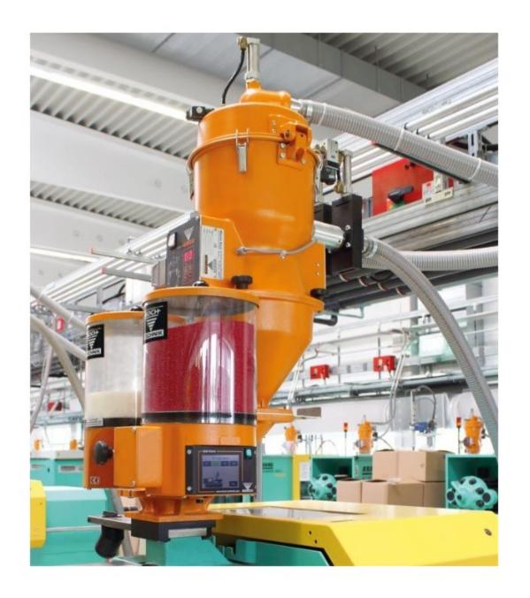
Dieser Aufbau ist ideal, wenn neben Masterbatch noch ein Antistatikum oder Flammschutzmittel dazu gegeben werden muss: Zwei KEM-TOUCH Geräte auf einem Adapterflansch. Das Hauptmaterial wird über den TM-Förderabscheider auf die Maschine gefördert.
