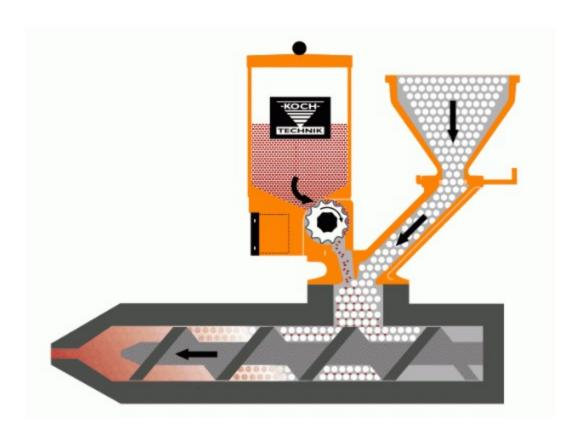
KEM-Geräte werden mit einem Flansch direkt auf den Materialeinzug der Verarbeitungsmaschine installiert. Das Rohmaterial fließt über einen freien Zulauf in die Maschine, wo auch Masterbatch oder Additive zudosiert werden. Die direkte Dosierung über Kammervolumen erlaubt eine exakte Zugabe von Granulaten sowie gut rieselfähigem Pulver und Mahlgut. sierung von kleineren oder größeren Mengen können die Dosierrollen sehr einfach und schnell getauscht werden.
