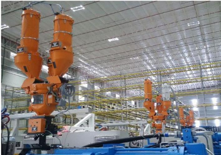
Fertigungslinie mit GRAVIKO GK 250 bei einem Kunststoffverarbeiter in Mexiko. Ein GRAVIKO GK kann ohne Werkzeug innerhalb von zwei Minuten zerlegt werden.
