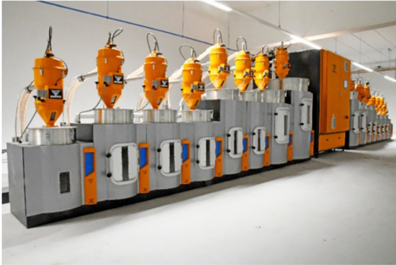
EKO-N: Trocknungsqualität auf höchstem Niveau - hier der EKO-N 1100F mit insgesamt 16 Trocknungsbehältern
